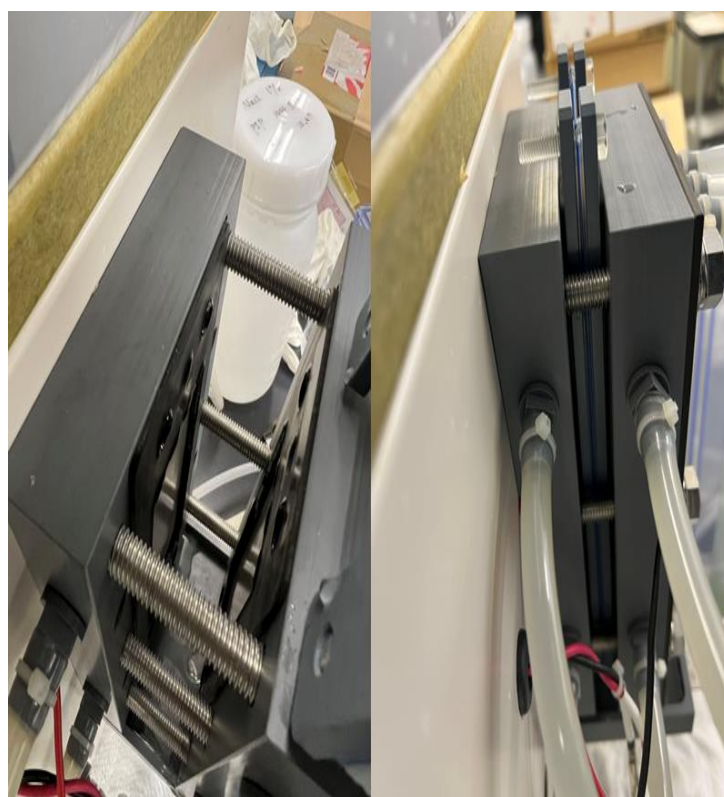
写真 3-4 : ゴム板により電極間距離の調整
