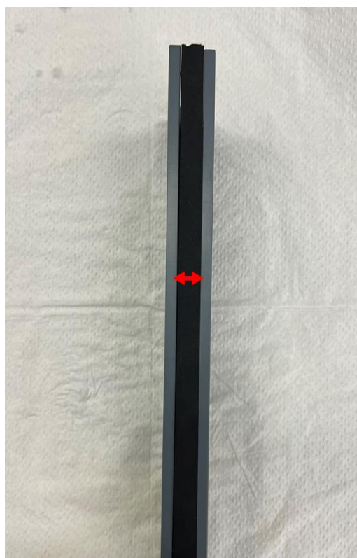
写真 3-3 : ゴム板により厚さ調整
