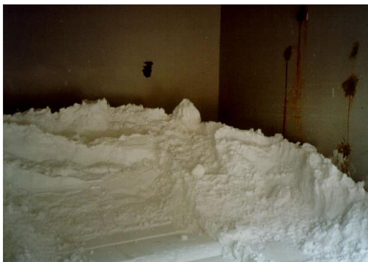
写真1-2-脱塩処理に伴い発生した副生塩 4)
