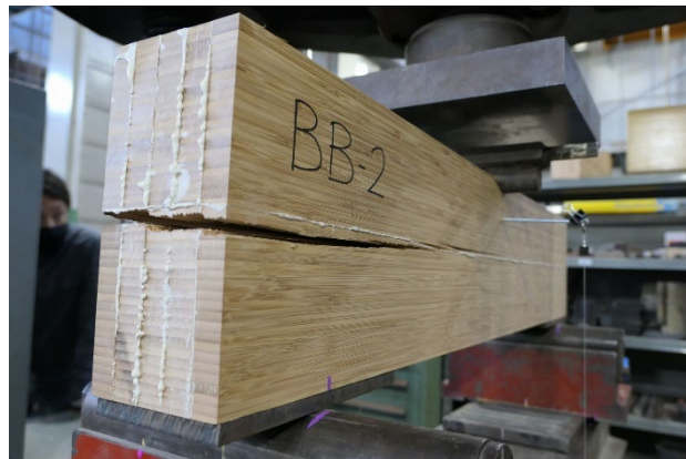
写真8：竹集成材の重ね梁の破断状況
