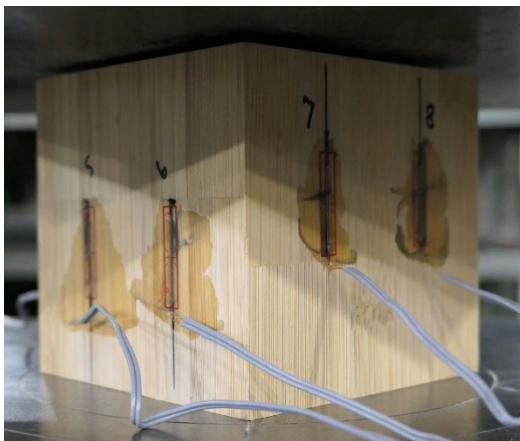
写真6：竹集成材(左)と木材(右)の圧縮試験の状況
