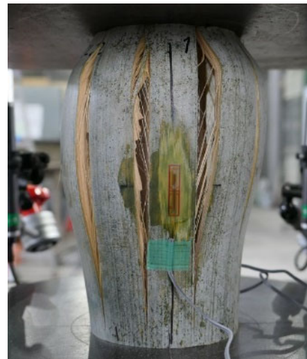
写真5：丸竹(CL1試験体)の圧縮試験(左)と最終状態(右)
