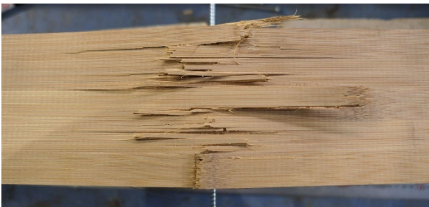
写真10：B試験体の破断状況（下面）
