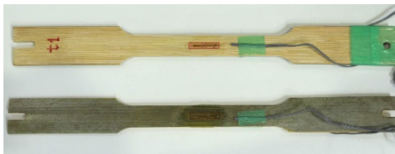
写真3：引張試験片の表と裏の状況
