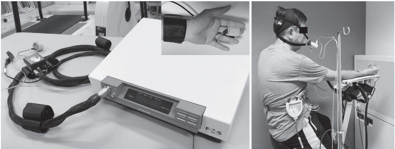
図2：連続血圧・血行動態測定装置(左)と実際の研究方法(右)
