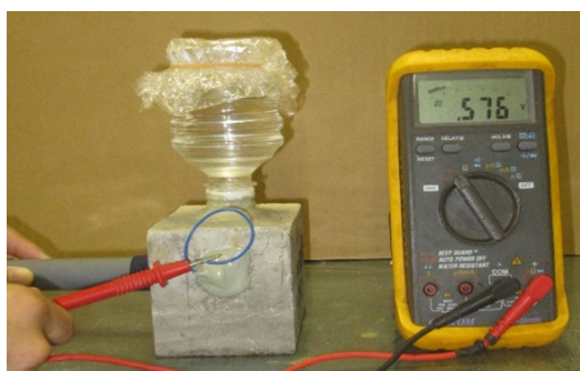
写真 5-20 自然電位の測定状況
