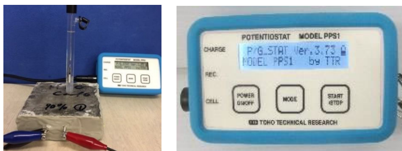
写真 5-12 ポテンシオスタットによる測定状況
