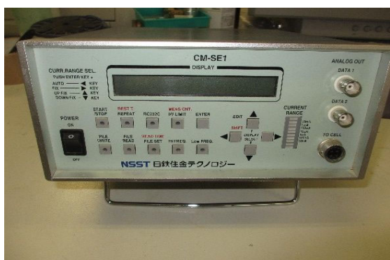
写真 5-21 分極抵抗の測定機器
