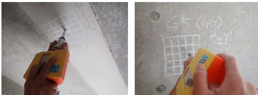
写真 5-2 リバウンドハンマーの実施状況
