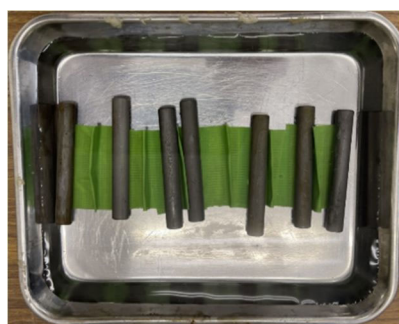
写真 5-14 クエン酸浸漬状況
