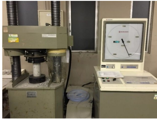
写真 5-1 圧縮強度試験の状況
