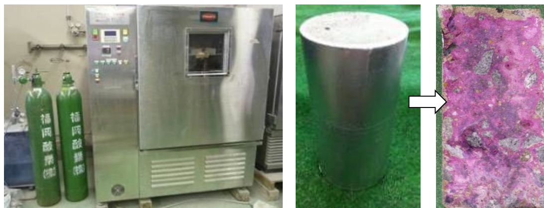
写真 5-6 中性化促進試験の状況
