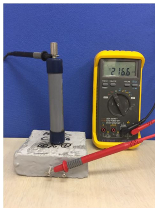
写真 5-11 自然電位の測定状況
