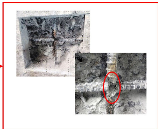
写真 5-5 実構造物の高濃度塩の化物イオン濃度を示したコンクリート内部の鋼材の状態
