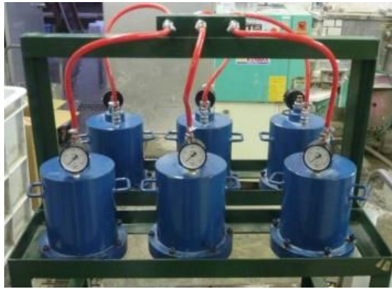
図 2-28 コアを用いた加圧法による透気試験
