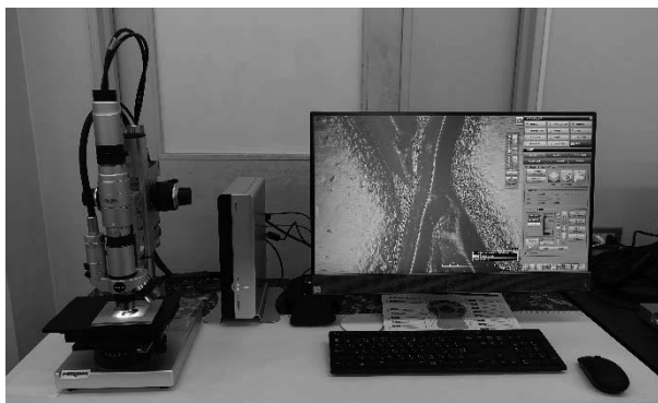
Fig. 4 デジタルマイクロスコープ (HiROX HR-2000)
