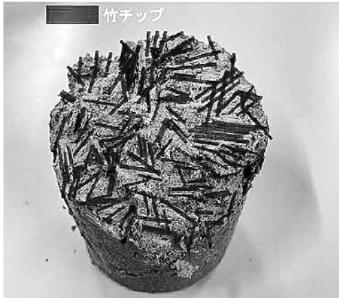
写真-6 B=50%の圧縮後の供試体断面
