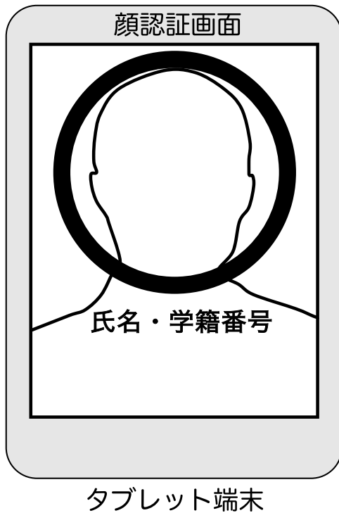
図2. タブレット端末の顔認証画面の例 顔認証が正確に行われると、タブレット画面の中央に大きな丸(○)と氏名・学籍番号が表示され、学生本人が出席登録の完了を確認できる。
