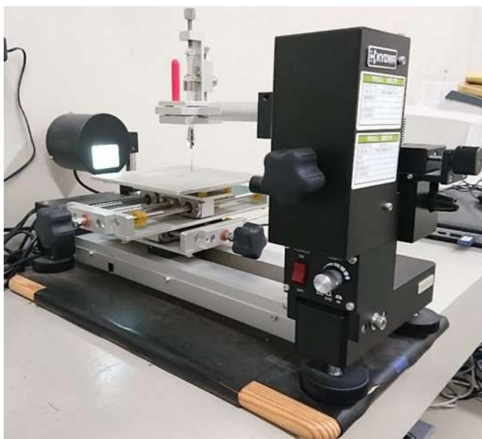
図 2-10. 接触角測定装置
