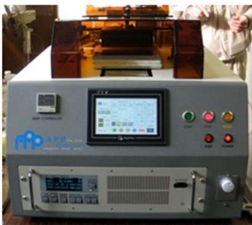
図 5-2. 大気圧プラズマ処理に用いた MyPL Auto-100DLC 装置
