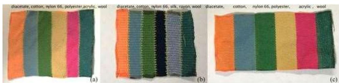
図 5-9. カヤステイン Q によるテスト織布の染色結果
