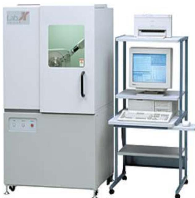
図 2-9. XRD-6100X 線回折装置
