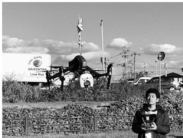
図1 マルチコプタによる超微粒子鉛直分布観測（2019年11月30日、田村花立広場）
