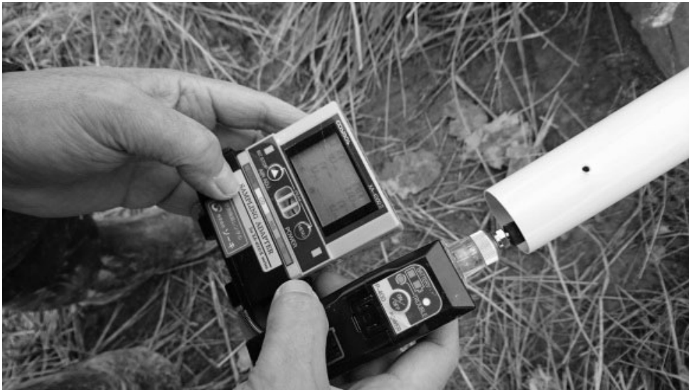
写真 - 2.17 ガス抜き管内の環境測定状況 2
