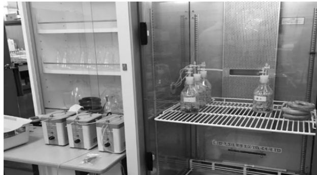
写真 - 2.1 通気による硫化水素ガス抑制実験状況
