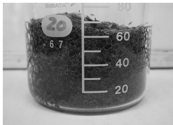
写真 - 4.5 ポリ硫酸第二鉄溶液撒布後の発泡状況
