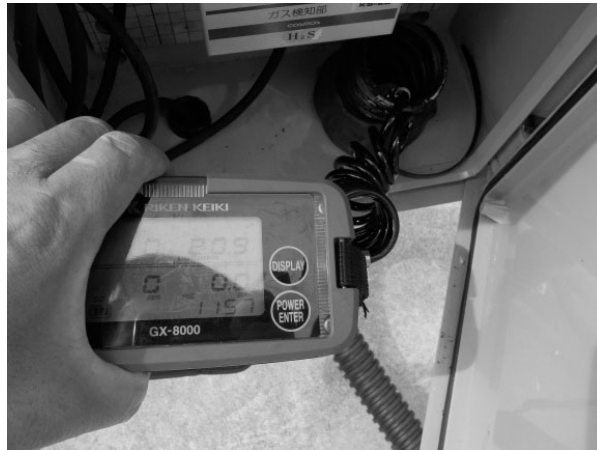
写真 - 2.14 硫化水素測定状況 1
