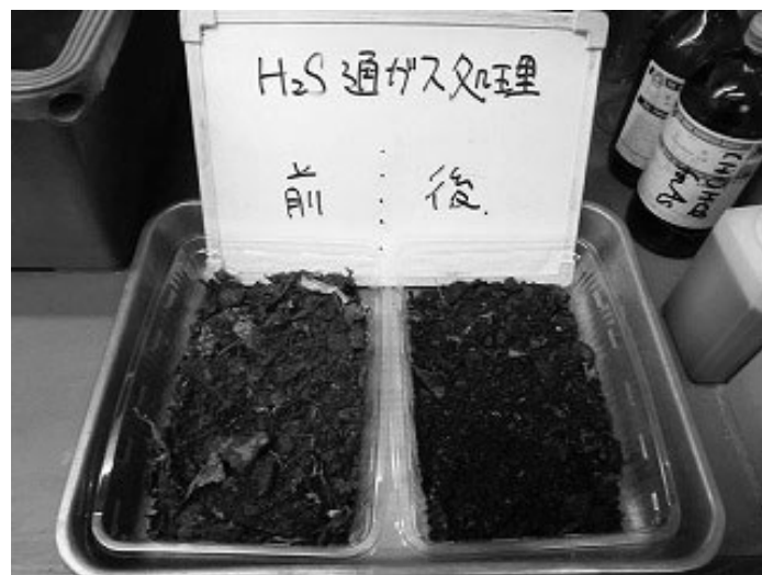
写真 - 4.4 資材添加廃棄物試料における硫化水素ガス通気前後の状況 (ガス通気による黒色化状況)
