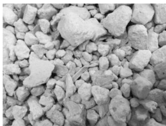
写真 - 2.4 物理組成 (石膏ボード)
