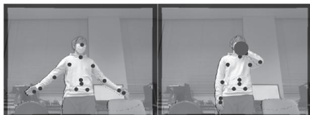
図5 Kinectによる服薬行動の検出
