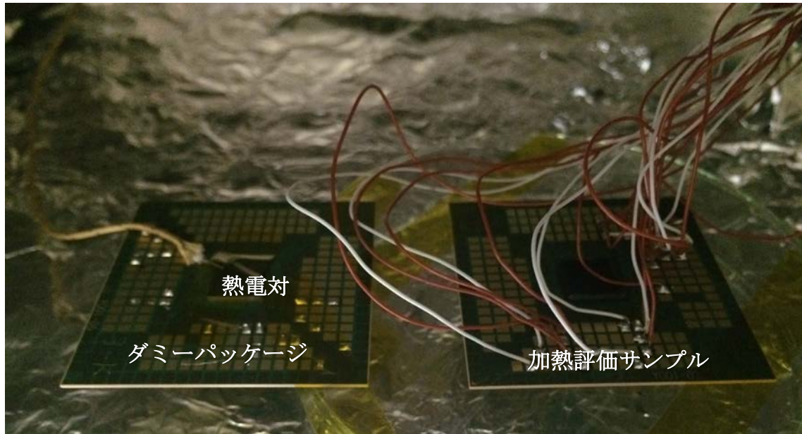
図 2.19 ベイク炉内の配線の様子
