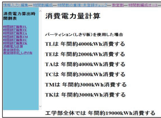
図 10 : パーティションを併用する場合での空調消費電力計算結果
