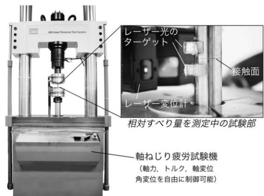
図2 疲労試験機を用いた往復すべり接触試験
