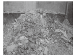
写真-2 解体系廃石膏
