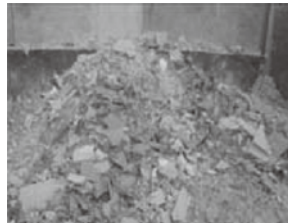
写真-2 解体系廃石膏
