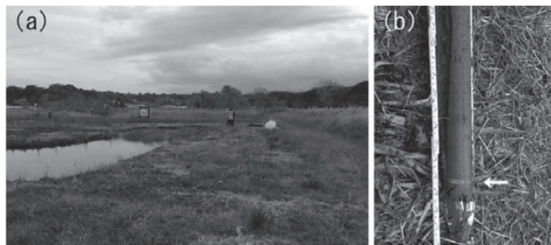
図5 唐比低地での掘削。(a)掘削風景。ピートサンプラーでの掘削。(b)泥炭層に挟在する唐比火山灰層(白矢印)。この火山灰層は、雲仙火山のblock-and-ash flow堆積物に伴うものと考えられる。
