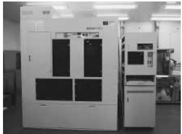
図5 微細パターンの露光装置
