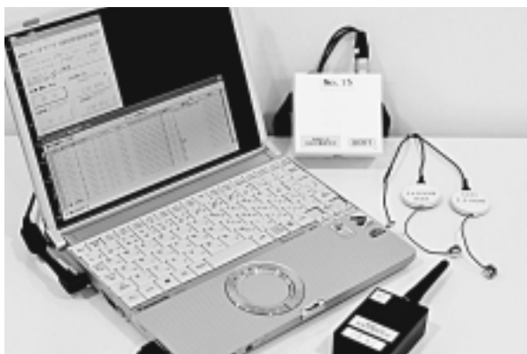
Fig 2 . 無線式心音検出・解析装置
