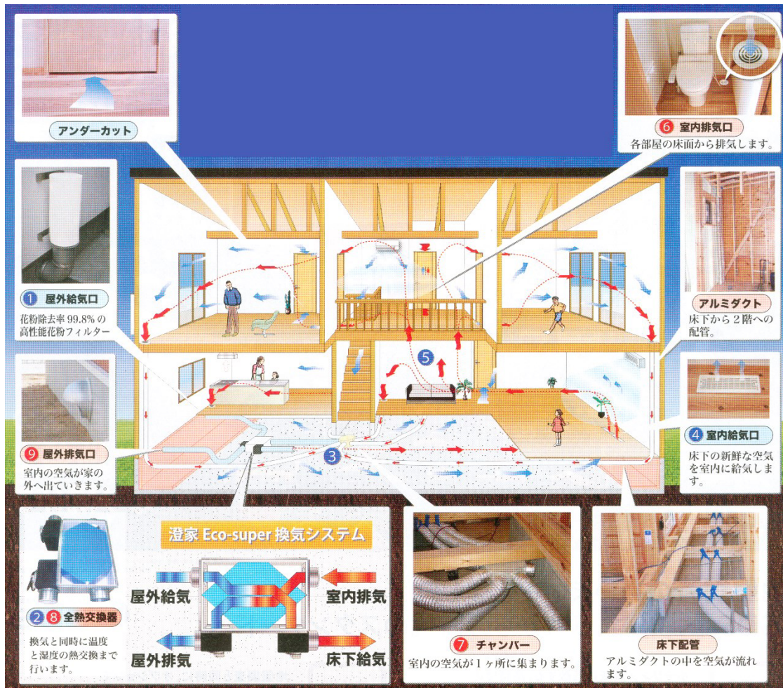
図3 住宅の換気・暖房・冷房の概要 1)
