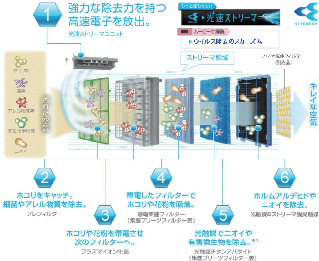
図 10 空気清浄機の構造<sup>11)</sup>
