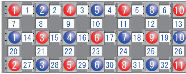
図3 自在調整局面ホルダに接続した照射用光ファイバと検出用光ファイバの接続位置
