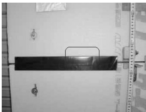
アクリル樹脂系Aのみが中央部の上端で一部剥がれが発生した。
