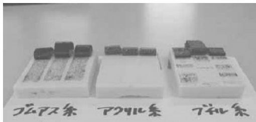
ブチルゴム系 A【右】とは凝集破壊, アクリル系 A【中央】は接着破壊, ゴムアス系 A【左】は凝集破壊である。
