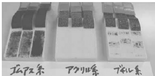
ブチルゴム系【右】は凝集破壊, アクリル系 A【中央】は接着破壊, ゴムアス系 A【左】は凝集破壊である。
