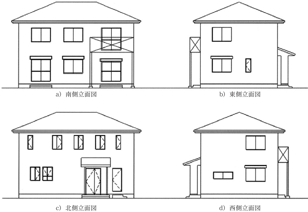
図18 戸建住宅のIV地域モデルの立面図（日本建築学会標準問題） (2)
