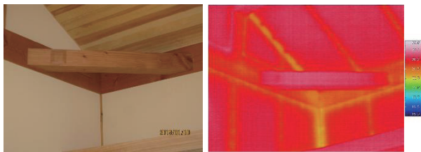
写真1 2階寝室における屋根面及び北側隅部の熱画像（Y木造住宅）、15時（2013.1/18）
