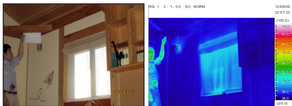
写真4 2階洋室の西壁と西窓の熱画像（Y木造住宅）、16時頃（2012.8/6）
